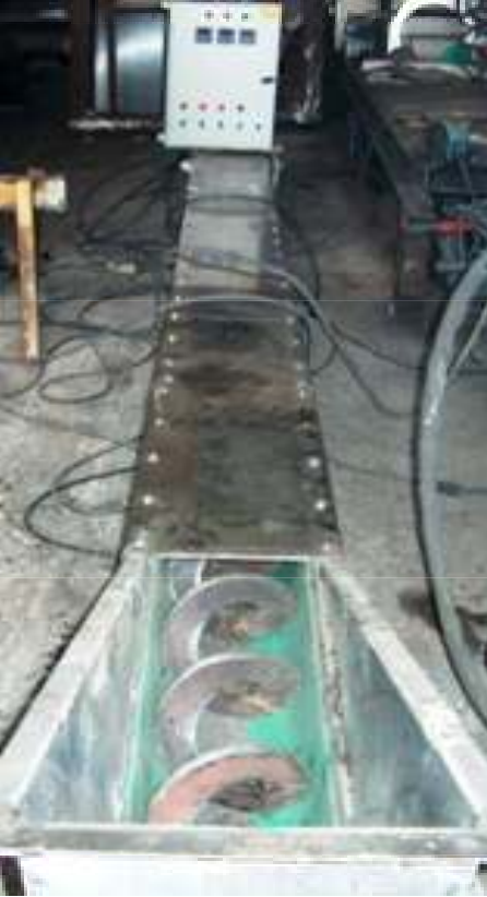
Spiral Susuzlaştırıcı: Atölye imalat safhası
